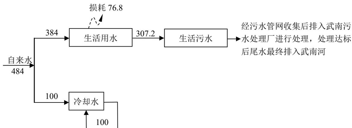
图 2-1 项目水平衡图 (单位: t/a)
