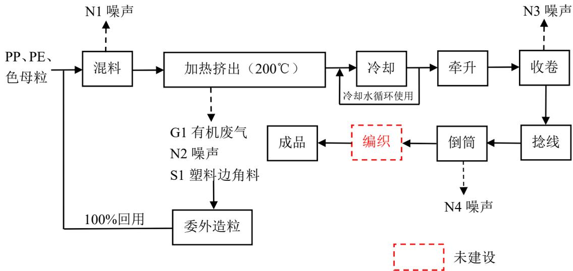
图 2-2 塑料制品生产工艺流程图
